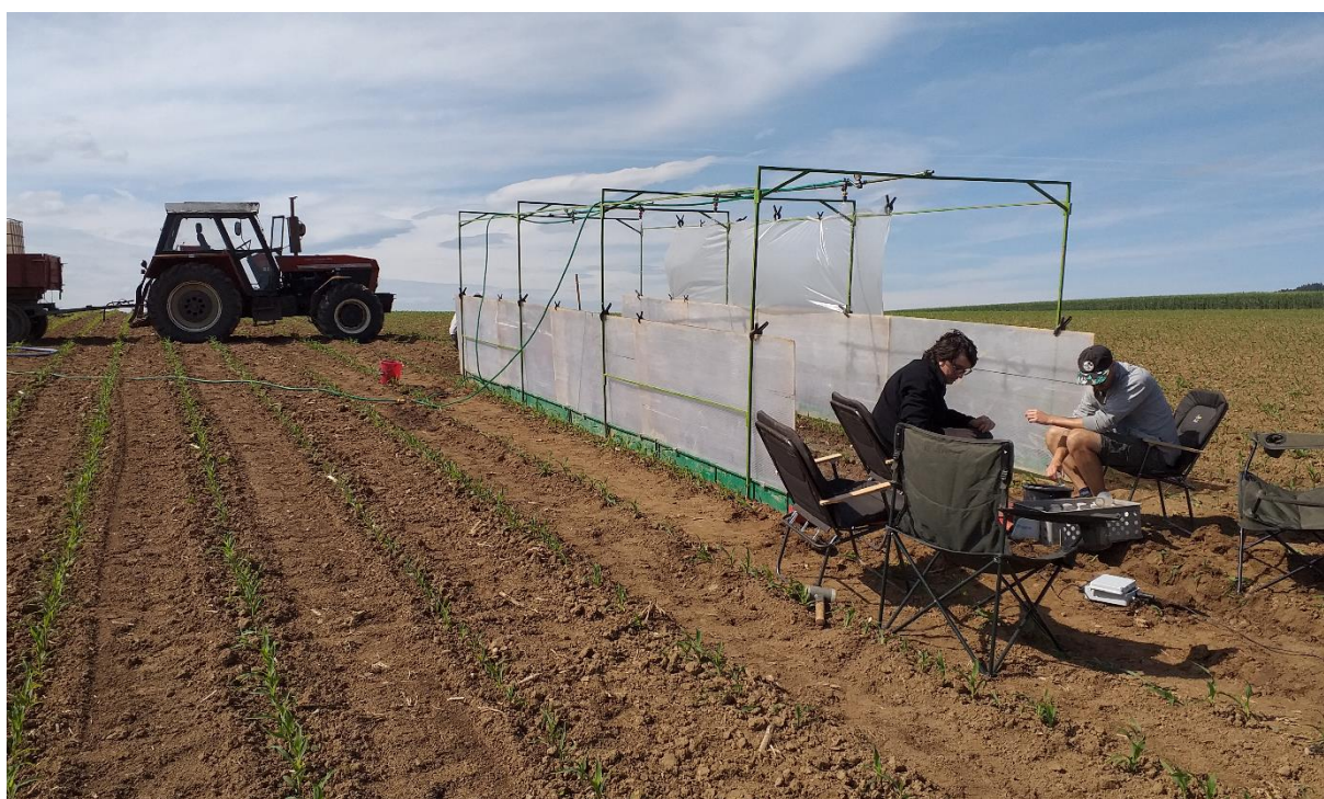
OBRÁZEK 6: POLNÍ SIMULÁTOR DEŠTĚ VYUŽÍVANÝ VE VÝZKUMNÉM ÚSTAVU MELIORACÍ A OCHRANY PŮDY, V. V. I.
