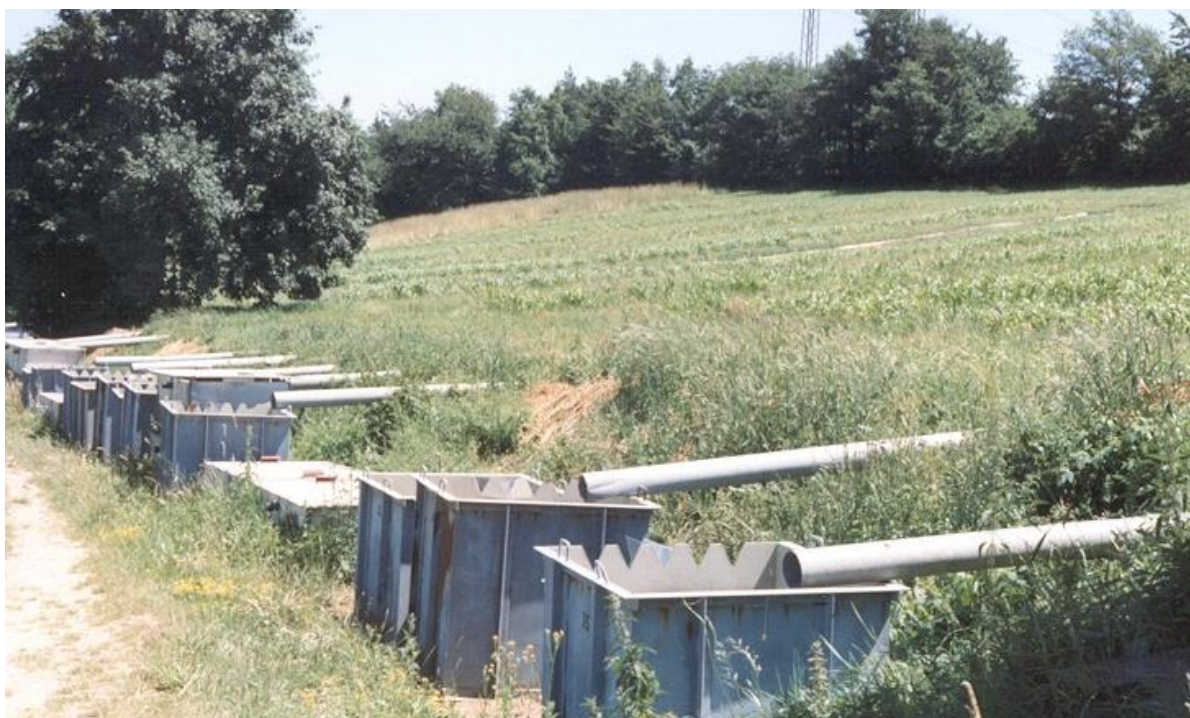
Obrázek 9: Záchytné nádrže na konci měřicí soustavy
