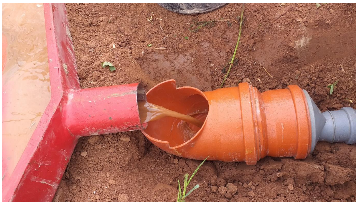
OBRÁZEK 7: POVRCHOVÝ OTOK A VYÚSTĚNÍ ZE SBĚRNÉHO ŽLABU, KDE DOCHÁZÍ K ODBĚRU VZORKŮ
